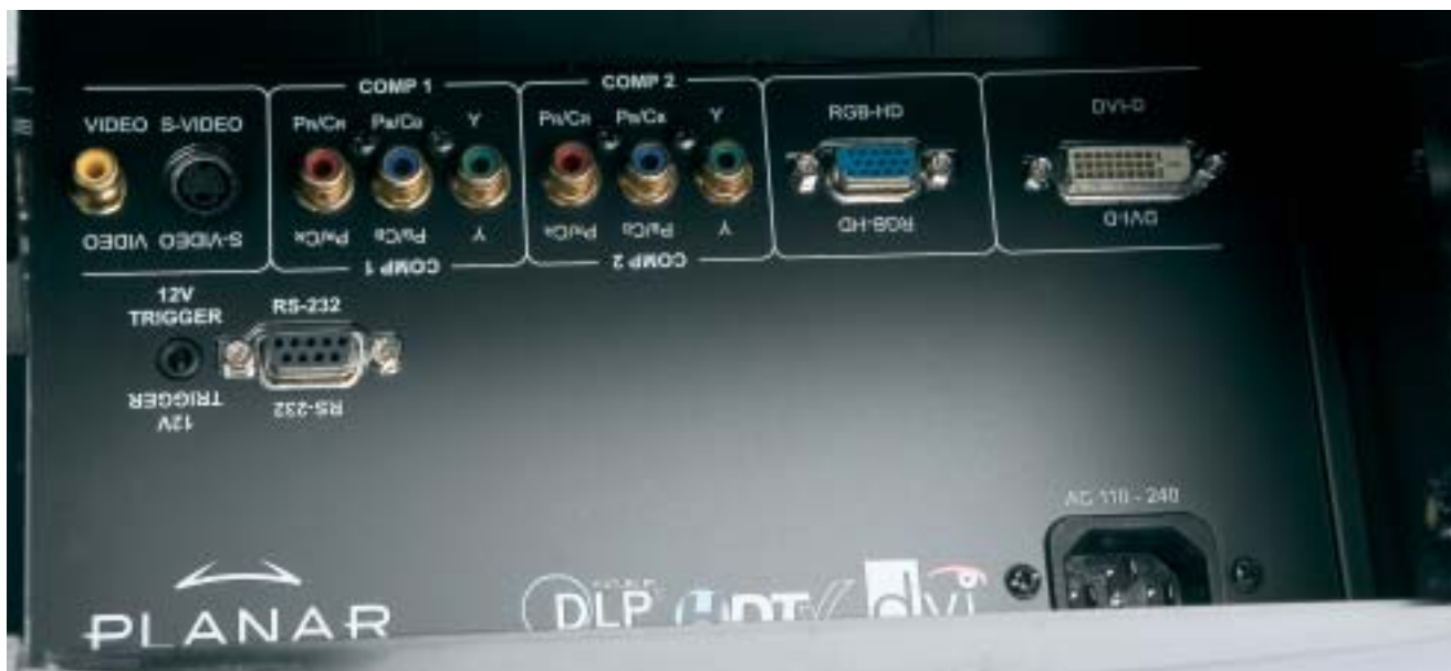
L'ingresso video digitale di cui dispone il Planar è di tipo DVI, per cui è necessario munirsi di un cavo adattatore qualora si disponga di una sorgente con uscita HDMI.
